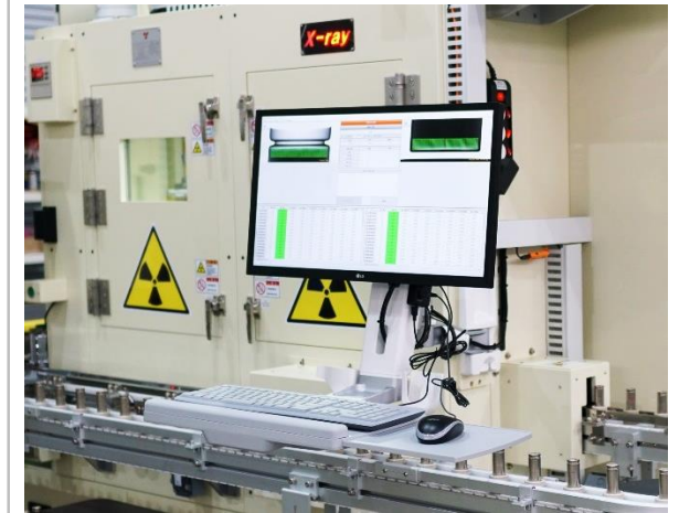
X-ray 이미지를 분석하여 불량을 검출하는 장치
